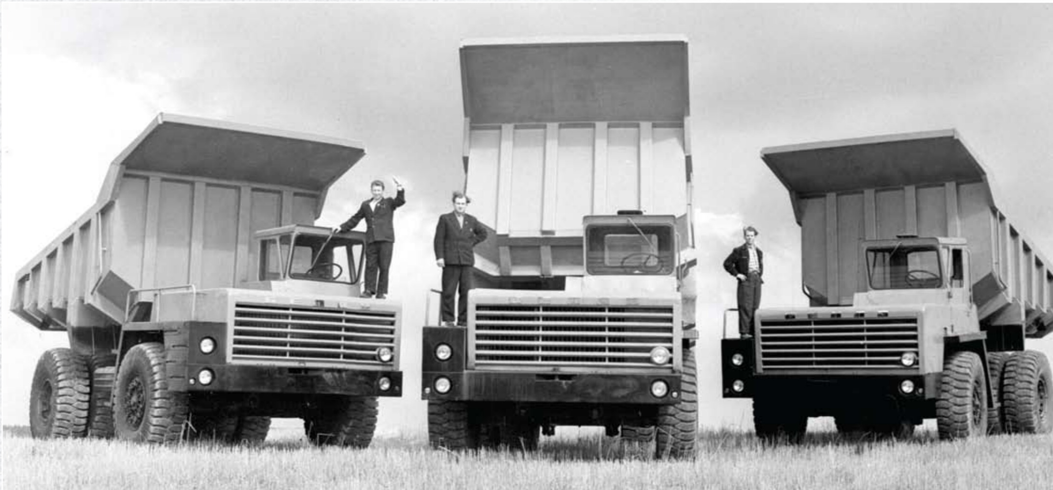
На Беларускаім аўтамабільным заводзе створаны доследны ўзор новага гіганта-аўтапоезда «БелАЗ-548В» грузападымальнасцю 65 тон. Тры белазаўскія багатыры. 27 жніўня 1963 г.
