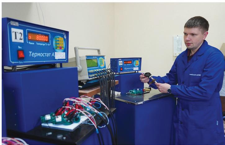
Проверка термометров сопротивления
