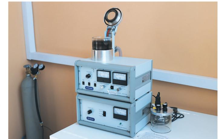
Установка для напыления тонких пленок
