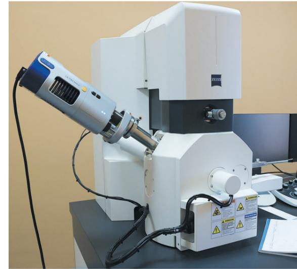
Сканирующий электронный микроскоп
