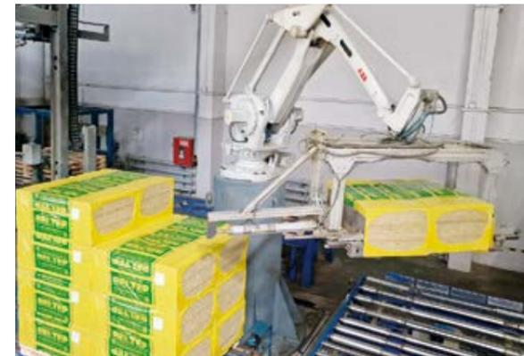
Упаковка плит теплоизоляционных из минеральной ваты BELTEP
